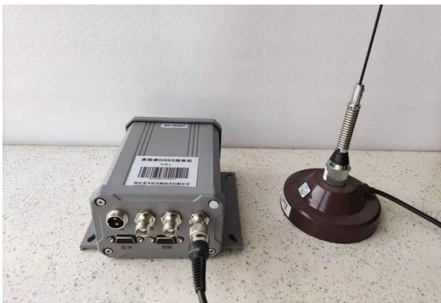
图 3-1 电台/4G 接口—接收天线
