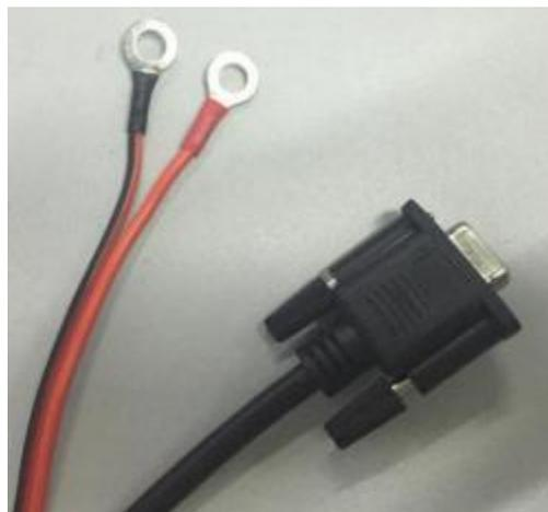
图5 圆形端子和 DB9 接头
