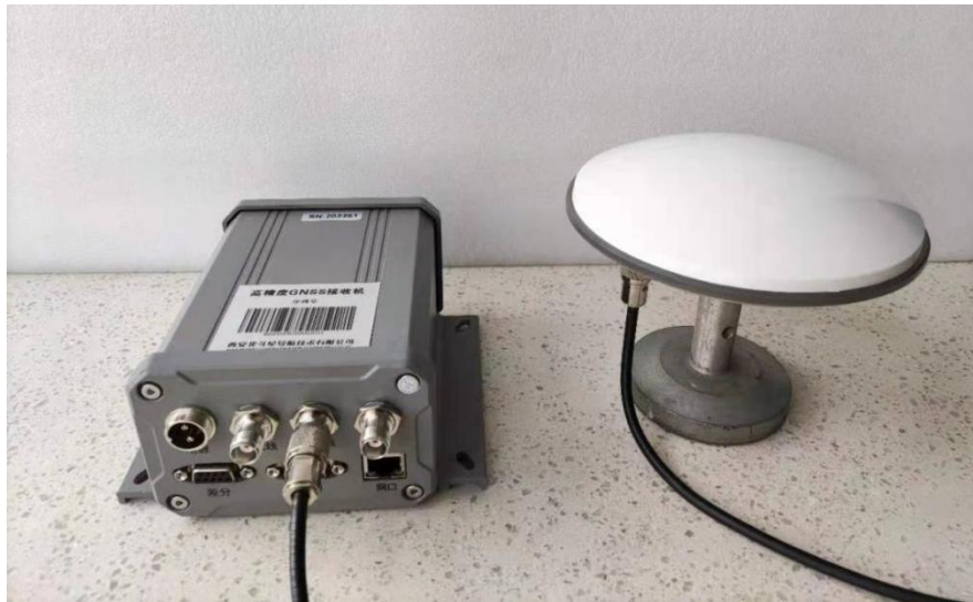
图 3-3 后天线接口—卫星天线
