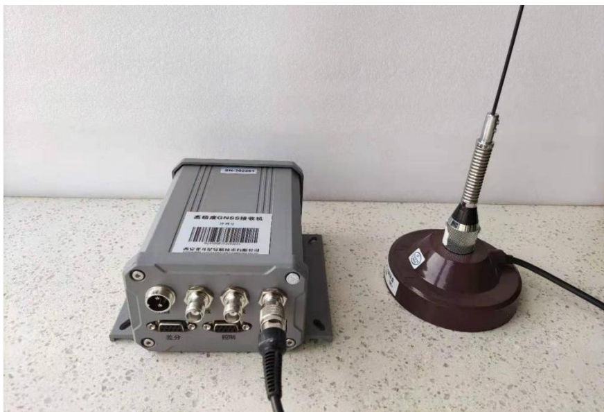
图 3-1 电台/4G 接口—接收天线
